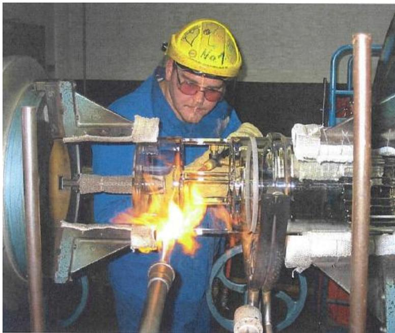
Der Mitarbeiter schützt sein Gesicht mit einem Schutzvisier Protector SHS!B und einer Didymiumbrille. Die Arme schützt er mit einem T-Shirt und einer Arbeitsjacke. Die Hände schützt er mit einem Kevlar-Handschuh.
